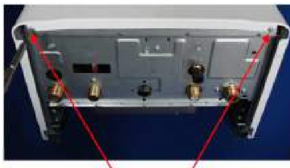
15.1 ábra: Burkolat-rögzítő csavarok (2 db)
