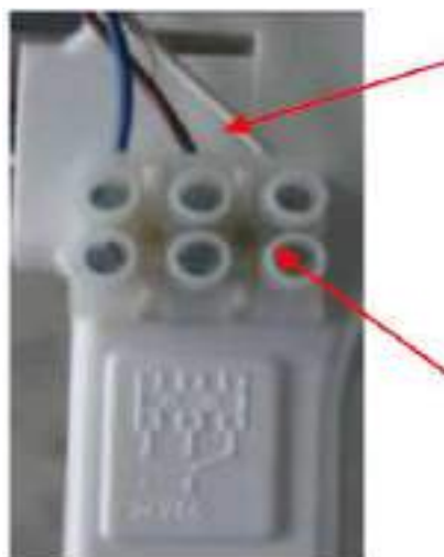
8.2 ábra: A CombiTEK készülék sorkapcsa a szobatermosztát számára
